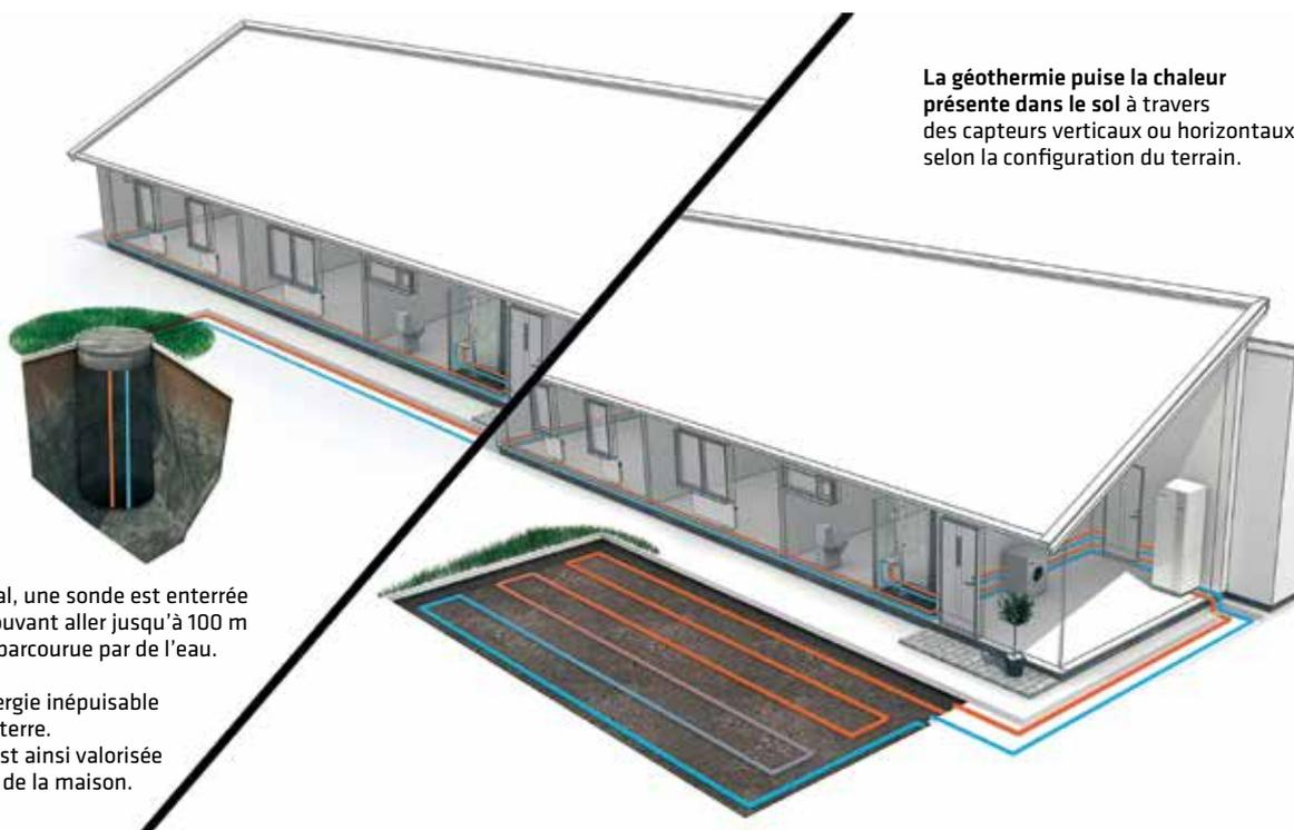
La géothermie puise la chaleur présente dans le sol à travers des capteurs verticaux ou horizontaux, selon la configuration du terrain.
